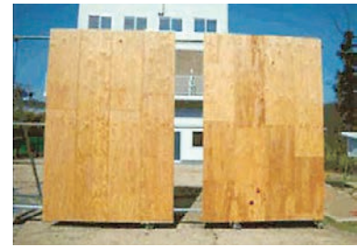
写真8-8 技術開発の例 (仮囲いの試作品)
