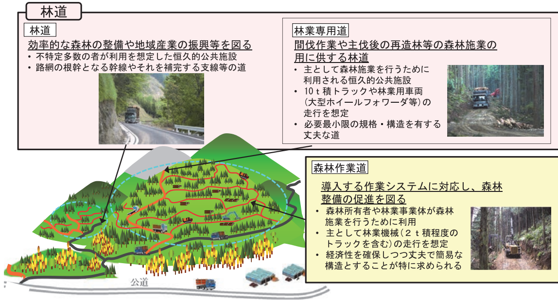
図6-4 林道(林業専用道を含む)、森林作業道の役割分担のイメージ
